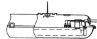
Double raccordement de câbles, tant sur le côté qu'au-dessus de l'appareil.
